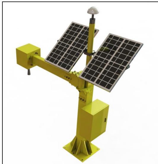
Sabit GNSS alıcısı entegreli radar deniz seviyesi ölçer istasyon prototipi.
